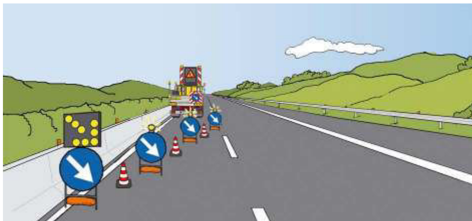
Figura 40 – Chiusura della corsia di sorpasso: installazione della testata di esclusione della corsia
