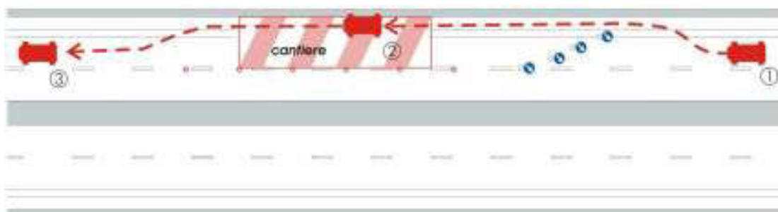
Figura 5 – Manovra di accesso e uscita dai cantieri in caso di chiusura della prima corsia (corsia di marcia)
