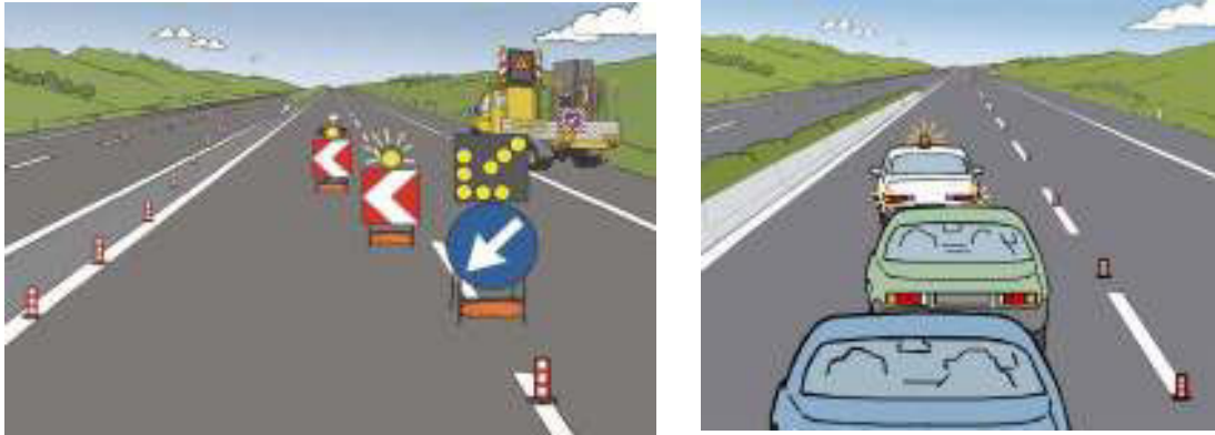
Figura 56 – Sbarramento per deviazione su carreggiata opposta
